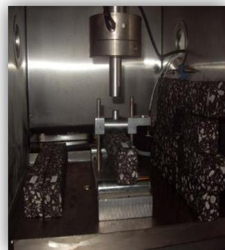
按T0703-2011中**轮碾机**成型的板块，用**切割机**制作棱柱体试件。
