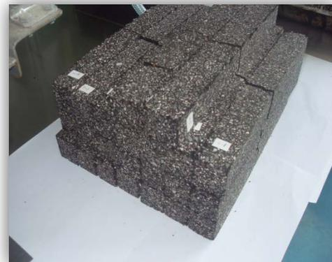
用 $-10^{\circ}\text{C}$ 小梁弯曲劲度模量评估常温改性乳化沥青混合料的技术指标要求
